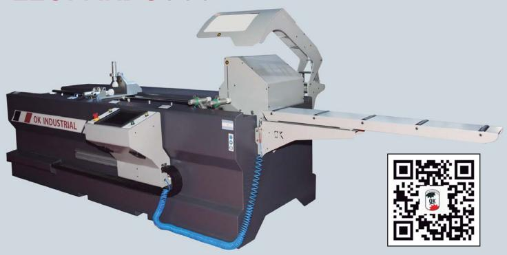
Cortadora con alimentador automático de barra para el corte secuencial y seriado de piezas de aluminio y plástico en cualquier ángulo entre 45°/0°/-45°.
