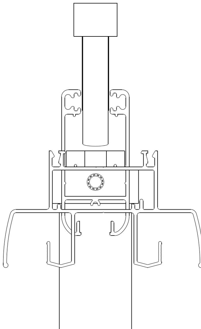
PARA MECANIZAR LAS HOJAS, SACAR LA HORQUILLA M45C12 Y COLOCAR EL TOPE EN POSICION H. PARA MECANIZAR EL MARCO COLOCAR HORQUILLA M45C12 Y TOPE EN POSICION M.
