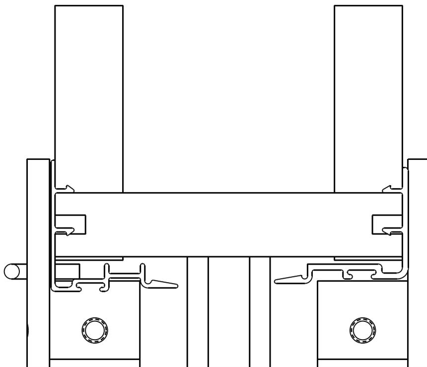
PARA EL PERFIL DE ALUAR 8051, SACAR EL SUPLEMENTO M45L40 ANTES DE MECANIZAR.
