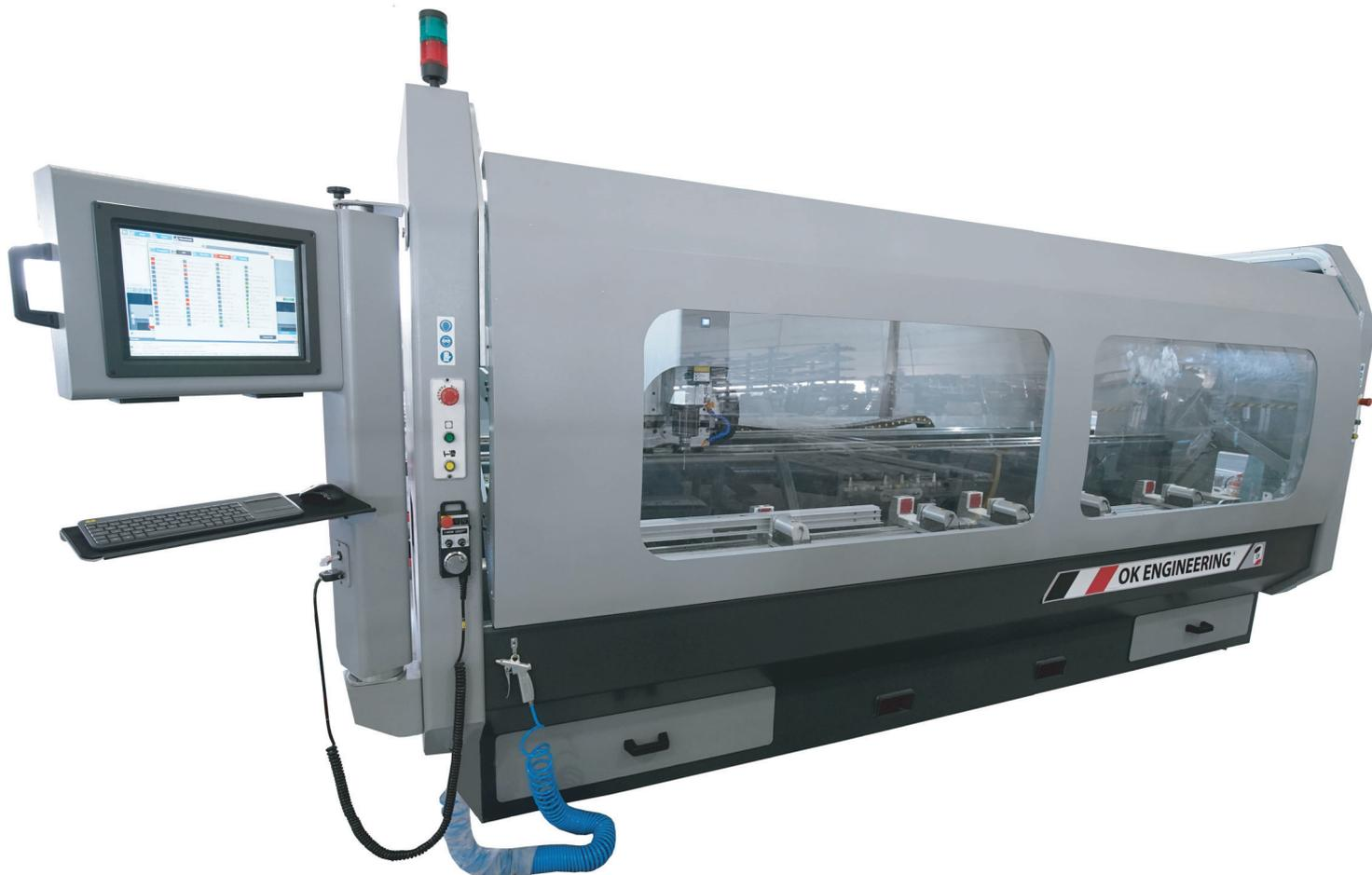
*Diseñado para el trabajo sobre perfiles de aluminio, PVC y aleaciones metálicas livianas (ferrosas o no ferrosas) de hasta 3mm de espesor, con bancada rotativa eléctrica para trabajar ángulos entre +90° y -90° y todos los ángulos intermedios, con cambio automático de 6 herramientas estándar ISO 30, construido con bancada monocasco, normalizada y mecanizada en una sola pieza, equipada con guías prismáticas en los 4 ejes.*
