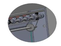
YAN DUVAR GİRİŞ AKTARMA SIDE WALL ENTRY TRANSMISSION
