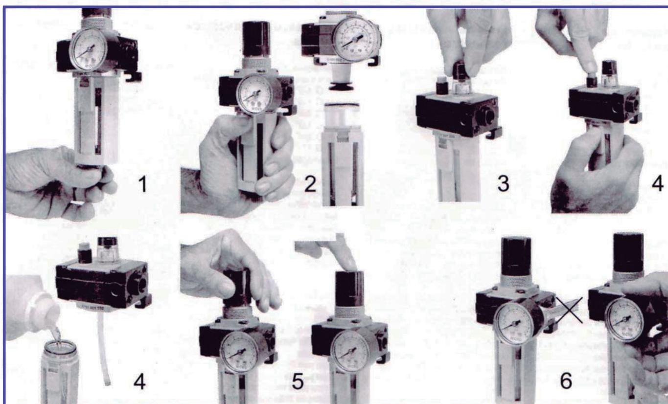
1) Evacuar periódicamente los condensados del filtro accionando manualmente la válvula de drenaje de modo que el nivel nunca alcance la campana plástica. Ajustar la válvula con la mano. No utilizar herramientas o pinzas.
