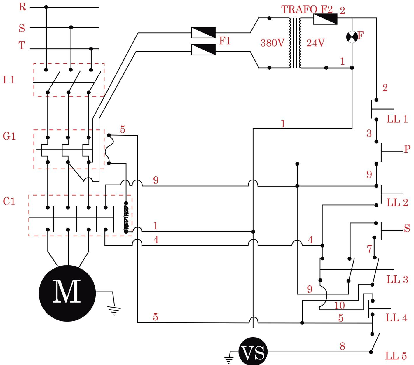
**F1** FUSIBLES 2A / **F2** FUSIBLES 2A / **I1** INTERRUPTOR GENERAL / **C1** CONTACTOR / **G1** GUARDAMOTOR
