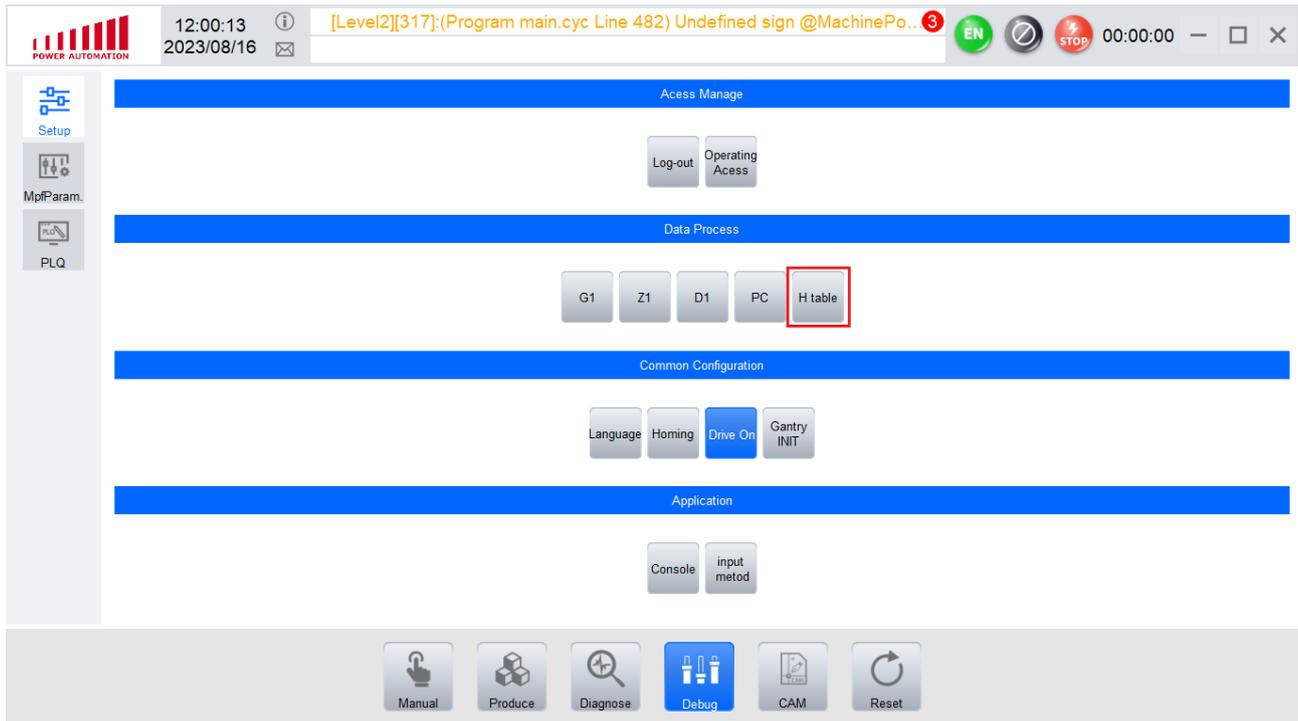
Luego le damos click en “H Table” y nos aparecerá una tabla como la de abajo, en esta podemos cambiar los valores si medimos alguna herramienta manualmente para que no se borre ese valor cuando apretemos el botón “Use tool length from cnc”.
